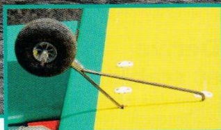
La soudure de la contre-jambe est peut être le seul point délicat pour un débutant total...
