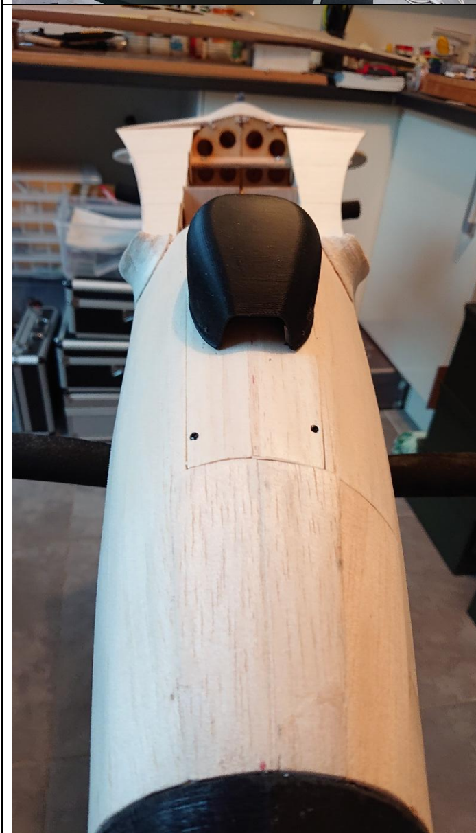
Radiateur avant, avec vue sur la trappe d'accès au contrôleur moteur.
