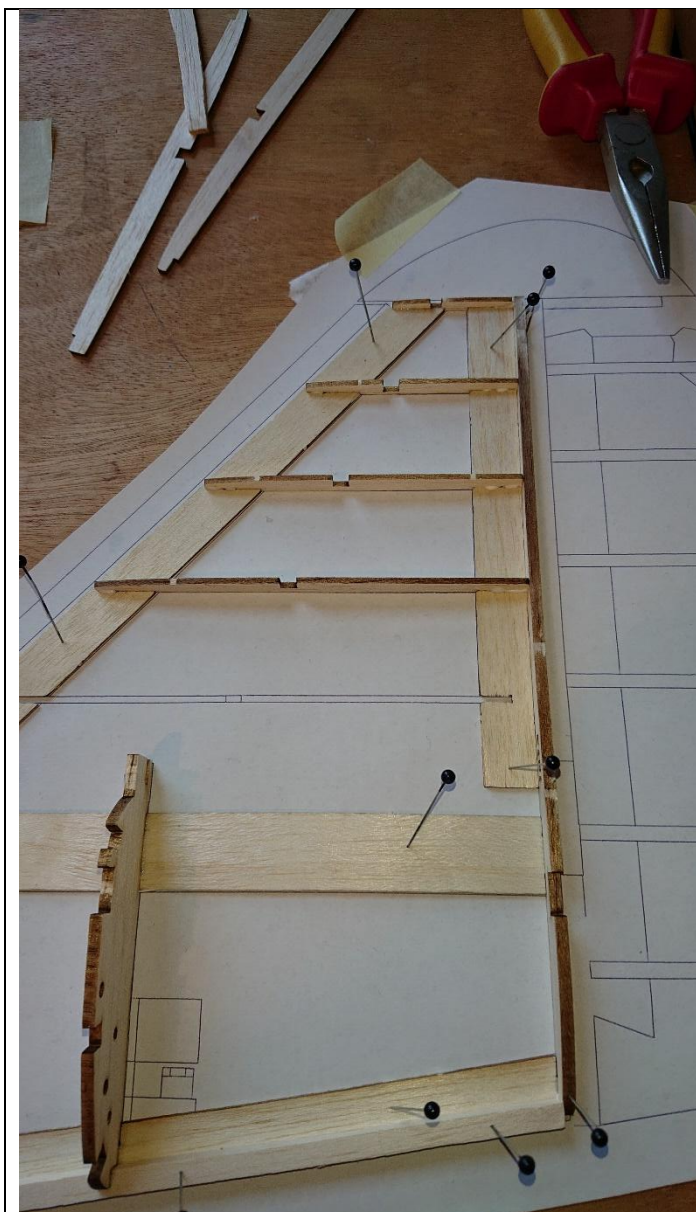
Collage des nervures de dérive D2 à D5
