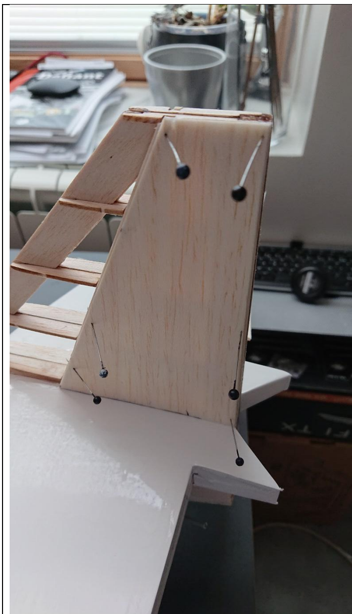
Coffrage de la dérive en balsa 20/10.
